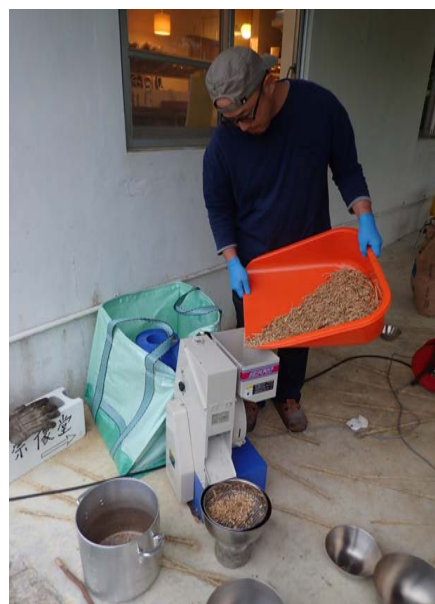
図8 籾摺り作業のようす（大竹製作所インペラ式籾小型摺り機を使用している）。小穂を籾摺り機に投入し、脱稈つまり籾殻を外す。写真は少量の場合であり、脱稈率が7-8割なので受け口にフルイを置き、皮の外れなかった小穂を再投入する。上位機種ではより大量の処理ができて脱稈率も非常に高い。ただし現在皮性小麦用の条件設定を進めているところである。
