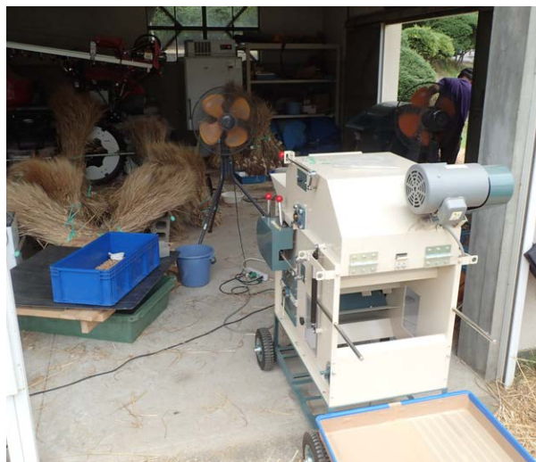
図7 脱穀。穂から小穂（つまり籾）を外す脱穀には、大屋式 DASH（大屋丹蔵製作所）の脱穀機を用いている。回転速度を自在に変えられるので、本品種の硬い芒を落としやすい。脱穀した小穂は、必要に応じて乾燥させたのちに、米袋やフレコンバックで貯蔵できる。
