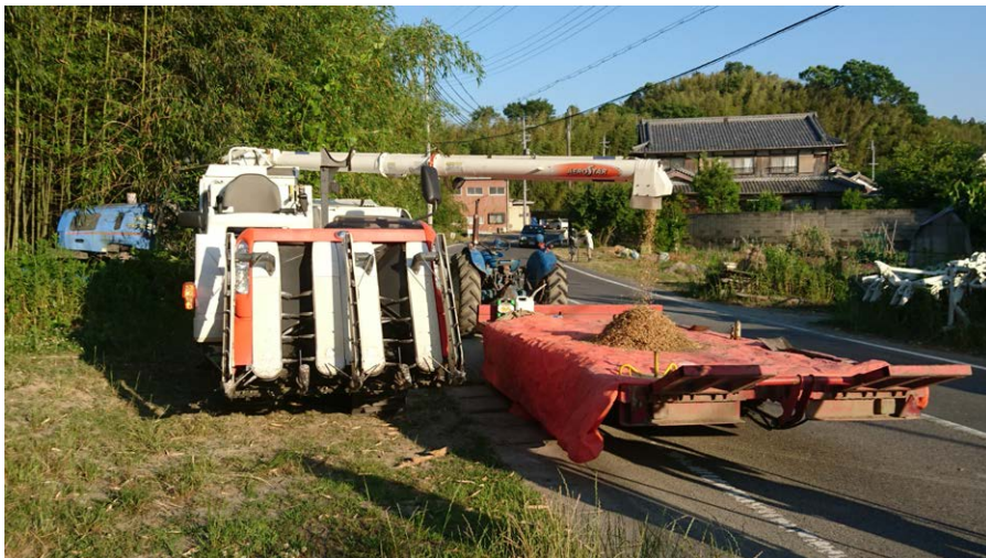
図 15 収穫麦をコンバインから出しているところ。本写真では取材撮影用のため台の上に出しているが、通常は乾燥施設で1日ほど乾燥させてからフレコンバックに移し、建屋で常温保存している。必要に応じて揺動式粉摺り機で麦粒をとりだして製粉している。
