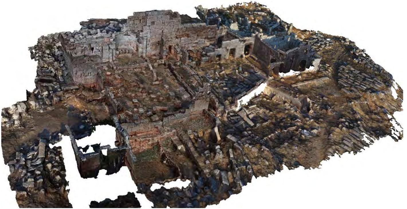
図 2 ドローン画像の計測結果と合成して周辺も含めた3次元モデル
