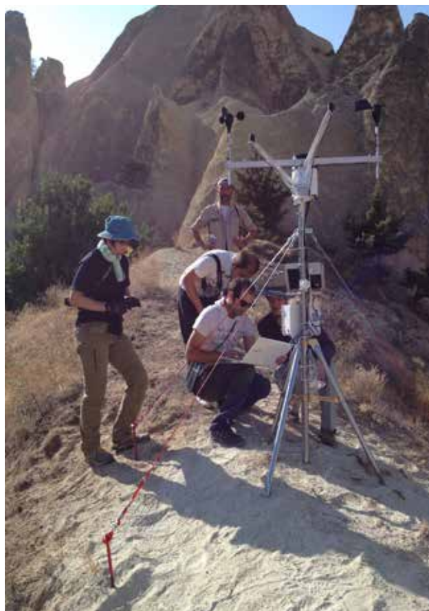
微小環境観測ステーションの設置
