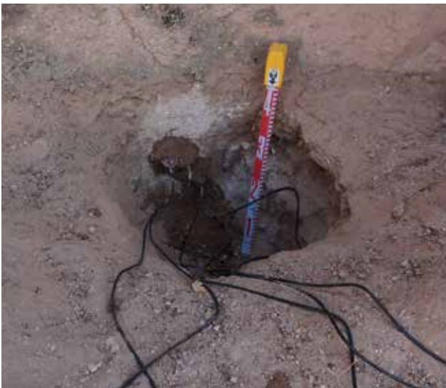
ウズムル教会周縁部への水分センサー埋設
