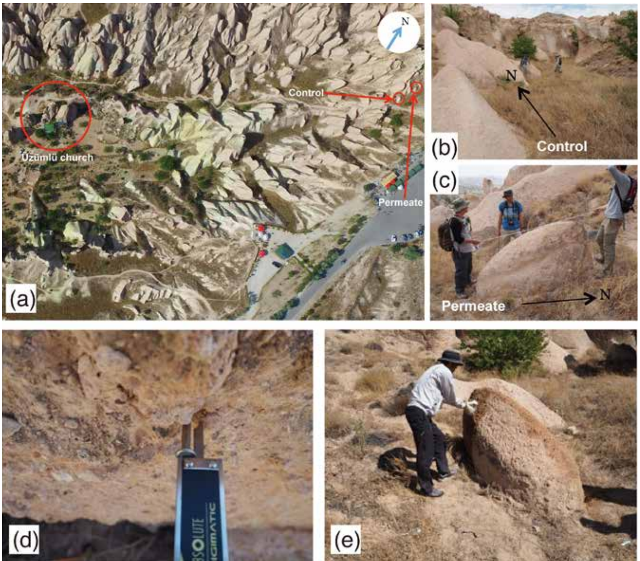
図7: a. b. c. ウズムル教会と封孔剤の塗布実験を行っている岩塊の位置、 d. 凝灰岩の風化速度の測定、e. 試験用の岩塊に封孔剤を塗布している様子
