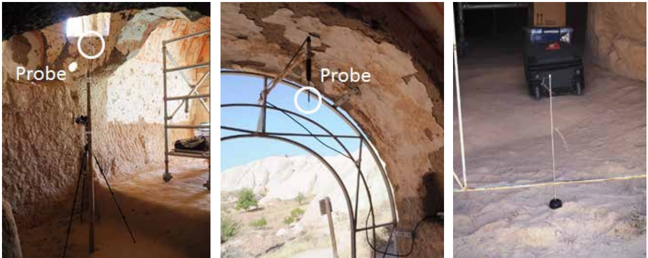
図4: 岩窟内の換気速度の調査
