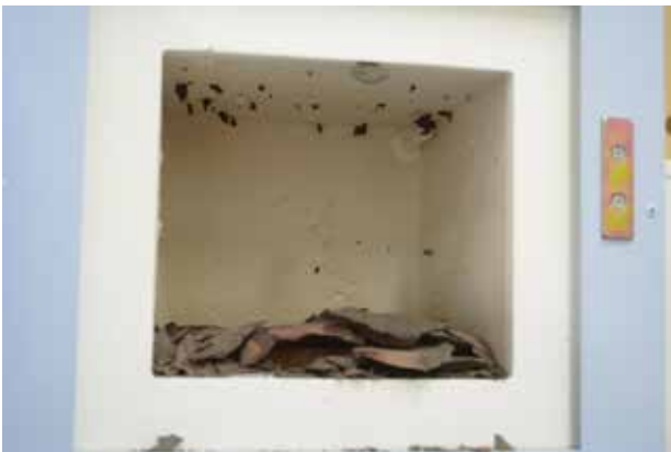
写真2 電気炉による石器加熱処理の復元実験(筑波大学)
