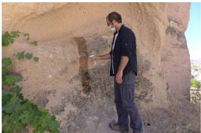
写真3 無機系封孔剤による凝灰岩表面の処理実験
